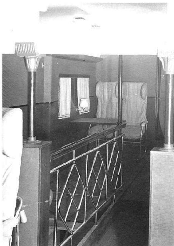
Макет самолета «МГ». Вход в самолет и третья пассажирская кабина
