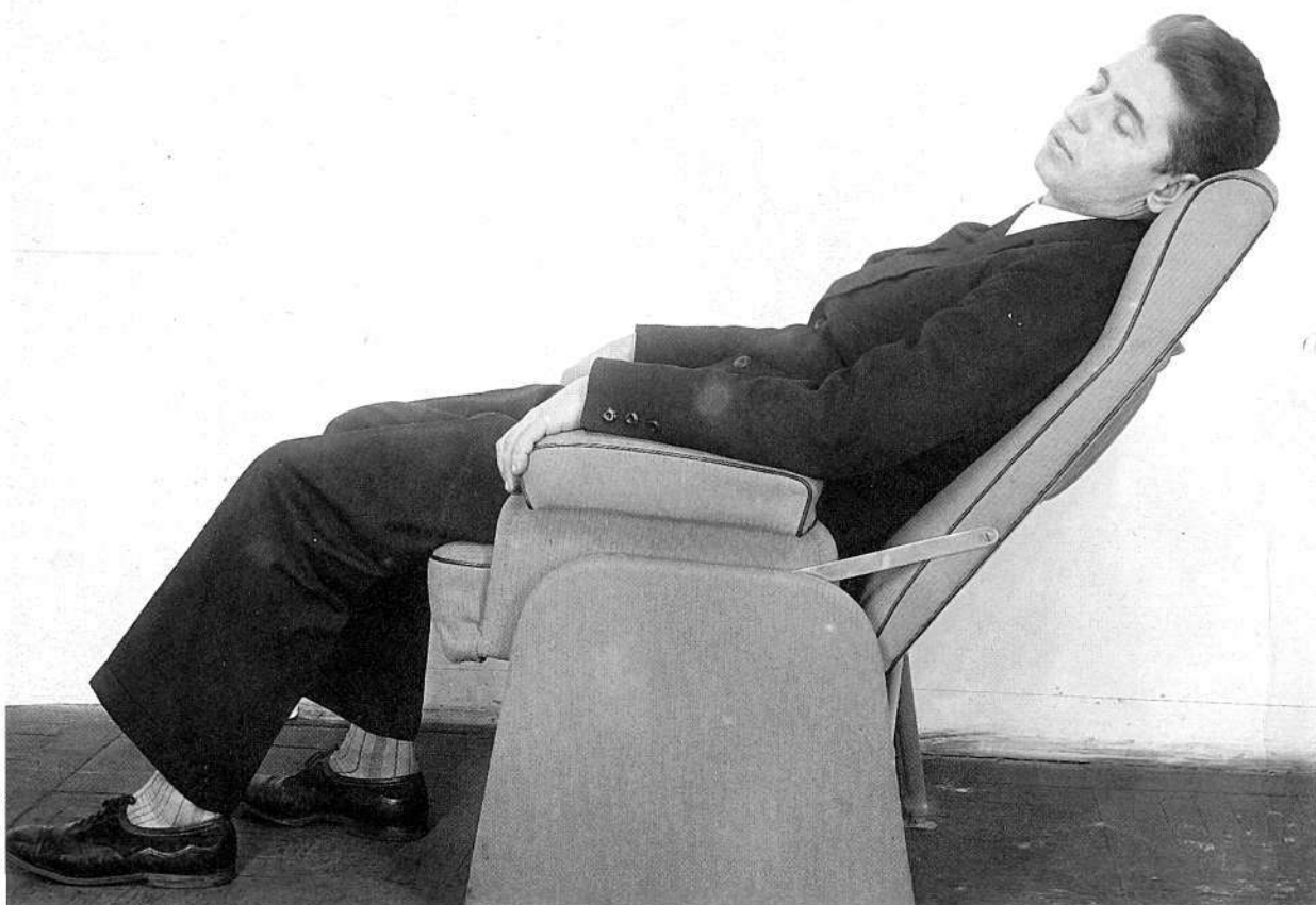
Макет самолета «МГ». Пассажирское кресло (внизу – в откинутом положении)
